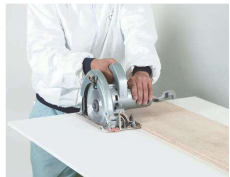
ストレートガイドを使った丸鋸での切断
