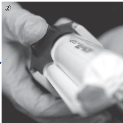
② カートリッジをレバーでしっかり固定します。
