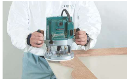
ルーター(テンプレートを使っての曲線切断)
