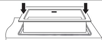
6 シンク裏の金具のネジを締める。裏打合板にツメが食い込み、シンクが固定する。
