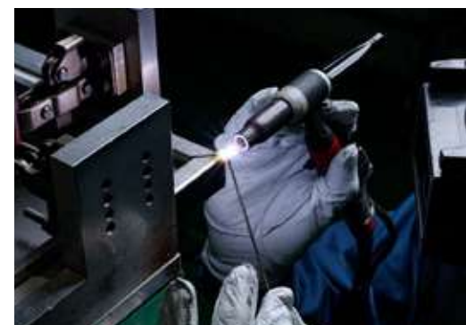
ワークトップコーナー部溶接作業
